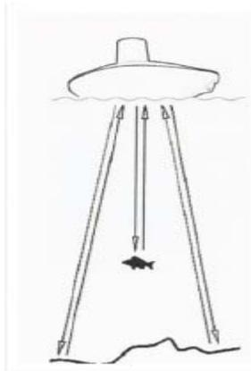
Технология эхолокации основана на звуковых волнах. С помощью данной технологии можно определить рельеф и структуру дна и глубину непосредственно под беспроводным/проводным датчиком (трандюсером). Трандюсер посылает звуковую волну и определяет расстояние до дна путем измерения времени между передачей звуковой волны и отражением ее от объекта. После обработки отраженного сигнала эхолот определяет местоположение, размер и тип объекта.
