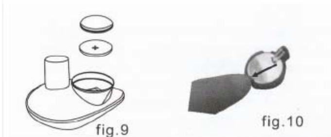
**7.1.** Снимите крышку батарейного отсека на беспроводном датчике и нажмите на защелку держателя батареи для ее освобождения
